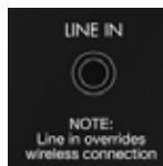
Sur le panneau arrière du LV1 se trouve une ligne d'entrée de 3,5 mm. Raccordez les appareils directement à l'aide d'un câble. Connectez votre station iPod/iPhone/iPad, ordinateur, téléphone portable, etc.
