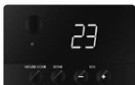
Sur la grille, vous trouverez les options : affichage, récepteur infrarouge pour la télécommande, voyant DEL, volume, canal de configuration (code maison), et la zone de paramètres du volume (zone).
