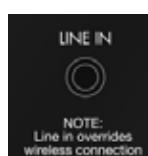
Op de achterzijde van DE LV1 bevindt zich een 3,5 mm lijningang. Sluit apparaten rechtstreeks met een kabel aan. Sluit een iPod/iPhone/iPad dock, computer, mobiel, enz. aan.
