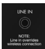
På baksidan av LV1 finns en 3.5mm stereoljudingång. Anslut direkt med kabel till iPod-docka, dator, mobiltelefon, etc.
