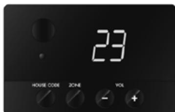
Kaiutinverkon alla on näyttö, kaukosäätimen infrapuna vastaanotin, LED-statusvalo, painikkeet äänenvoimakkuuden, kanavan (talokoodi) sekä äänenvoimakkuusalueen (alue) säätämistä varten.
