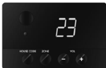
Onder de grille vindt u het weergavescherm, de infraroodontvanger voor de afstandsbediening, de LED-statusindicator, de geluidsregeling (VOL), de kanaalkeuze (House Code, huiscode) en de instelling voor de geluidsregelingszone (Zone).
