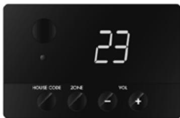
Under tygfronten finner du display, IR-mottagare för fjärrkontroll, LED statusindikator, volymkontroll, inställning av kanal (House Code), och inställning av volymzon.
