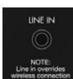
En el panel trasero del LV1 se encuentra una entrada de línea de 3,5 mm. Conecta los dispositivos directamente mediante cable. Conecta una base para iPod/iPhone/iPad, un ordenador, un teléfono móvil, etc.
