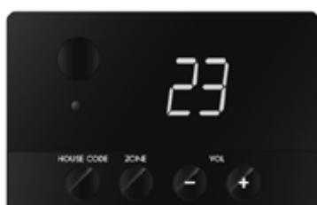
Bajo la rejilla encontrarás la pantalla, el receptor de infrarrojos para el mando a distancia, el indicador de estado LED, el volumen, la configuración del canal (Código de Casa) y la configuración del volumen de zona (Zona).
